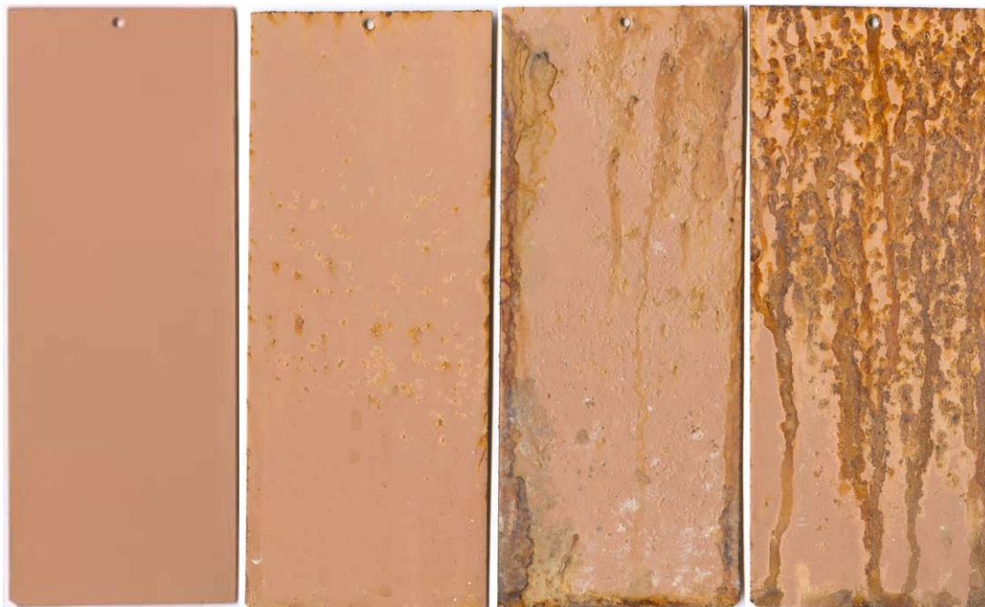
Obr. 1: Hammerite, nátěr na čistém povrchu plechu. Zleva - etalon, vzorky po expozici v KK, SO 2 , solné mlze.
