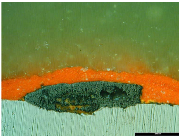
Obr. 5: Antirezin, metalografický pohled, nátěr na zkorodovaném povrchu, úsečka vpravo dole má velikost 200 \mu\text{m}
