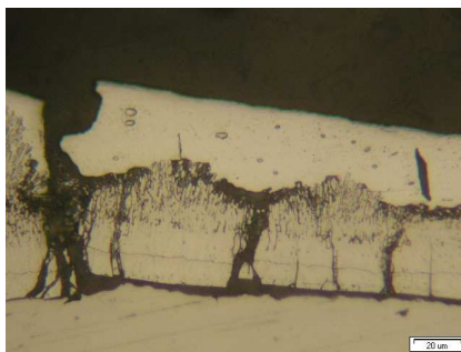
Obr. 9. Metalografický snímek odlupu Zn-Fe vrstvy u vzorku popuštěného 1h při 300 °C
