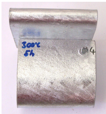
Obr. 4. Vzorek 160x65x1,0 po zkoušce ohybem
