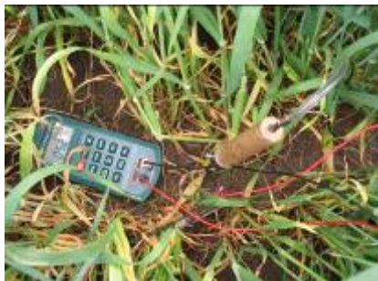
Obr. 1: Měření elektrické kapacity kořenového systému ve fázi sloupkování
