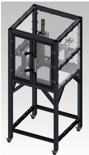
Obr. 3 Nosná konstrukce Rapi 3D
