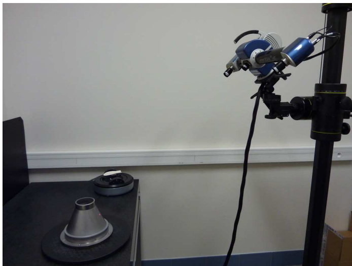
Obr. 3 Měření součásti 3D skenerem
