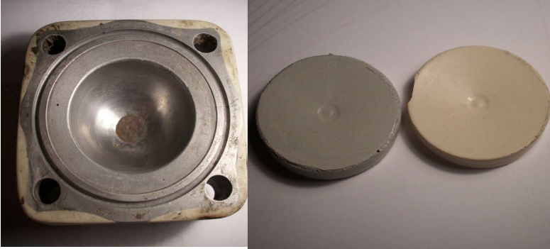
Obrázek 2: Originální hlava válce, předloha Obrázek 3: Vulkanizovaný kaučuk, vlevo s hliníkovým práškem, vpravo v čistém stavu
