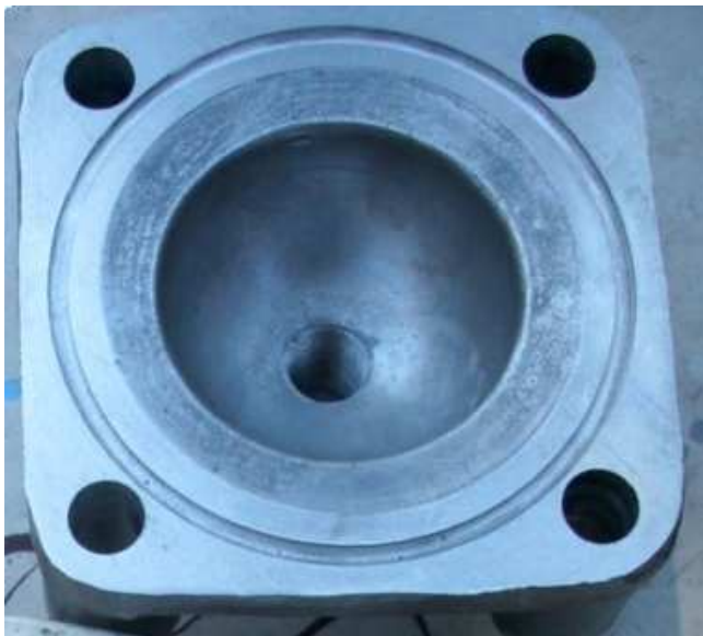
Obrázek 5: Finální odlitek po třískovém obrobení dosedací plochy
