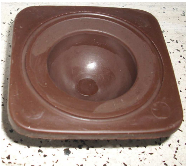
Obrázek 4: Vnitřní spalovací prostor na voskovém modelu po vyjmutí z formy
