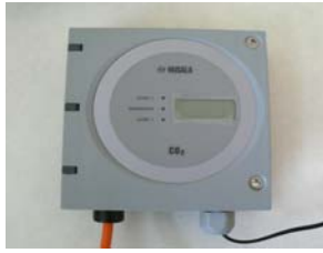
Obr. 1 Přístroj Vaisala GMT220 (část s odečtem měřících hodnot)
