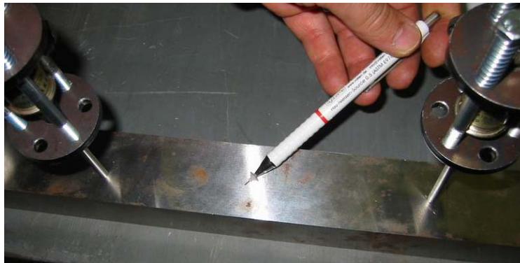
4: Ukázka Pen testu a výběr snímačů
