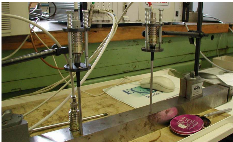
5: Sestavení vlnodů na měřící tyči
