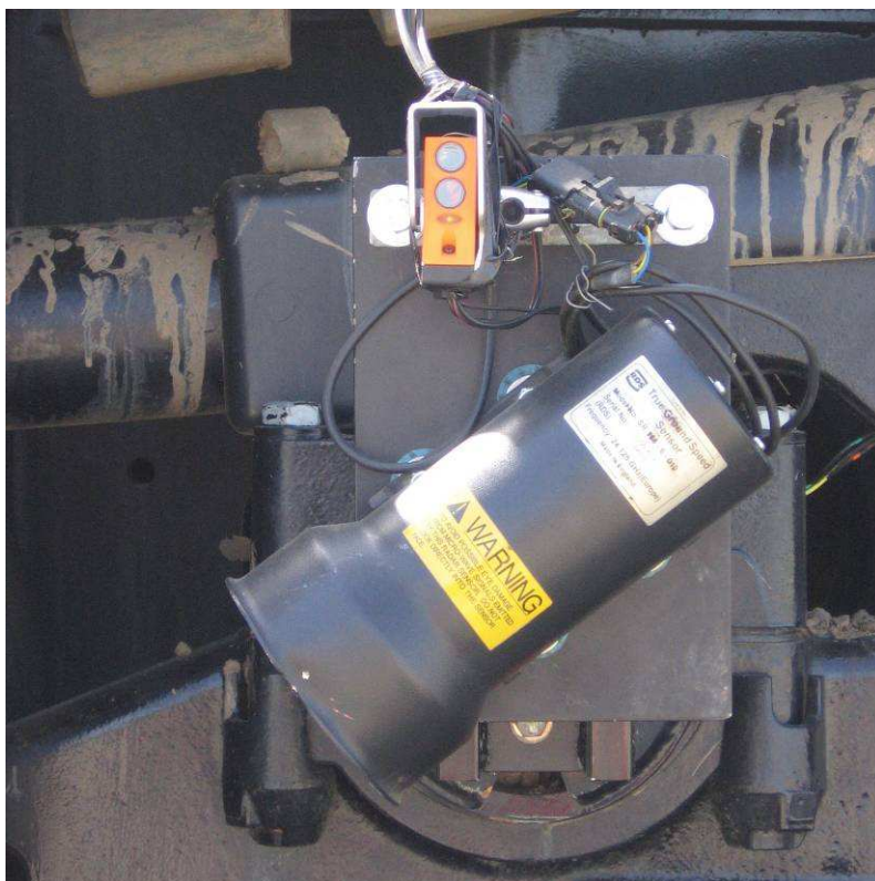
Obr. 6 – Radar RDS TGSS model SR 168-6-010 s reflexní optickou závorou IFM
