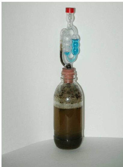
Obr. 1 Anaerobní kvasná láhev s pěnou z odpadních brambor
