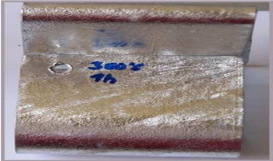
Obr.2 Ukázka připraveného žárově zinkovaného vzorku
