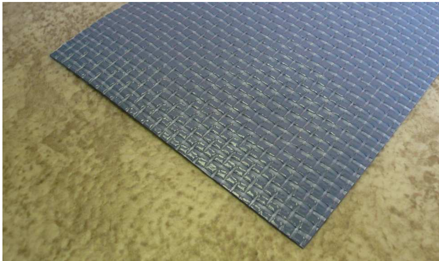
Obr. 5 - jednostranný nános PVC na PES mřížce
