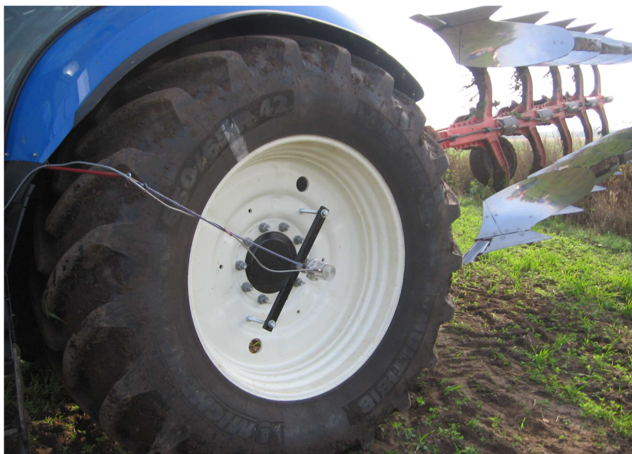
Obr. 4 Snímač otáček zadního kola traktoru
