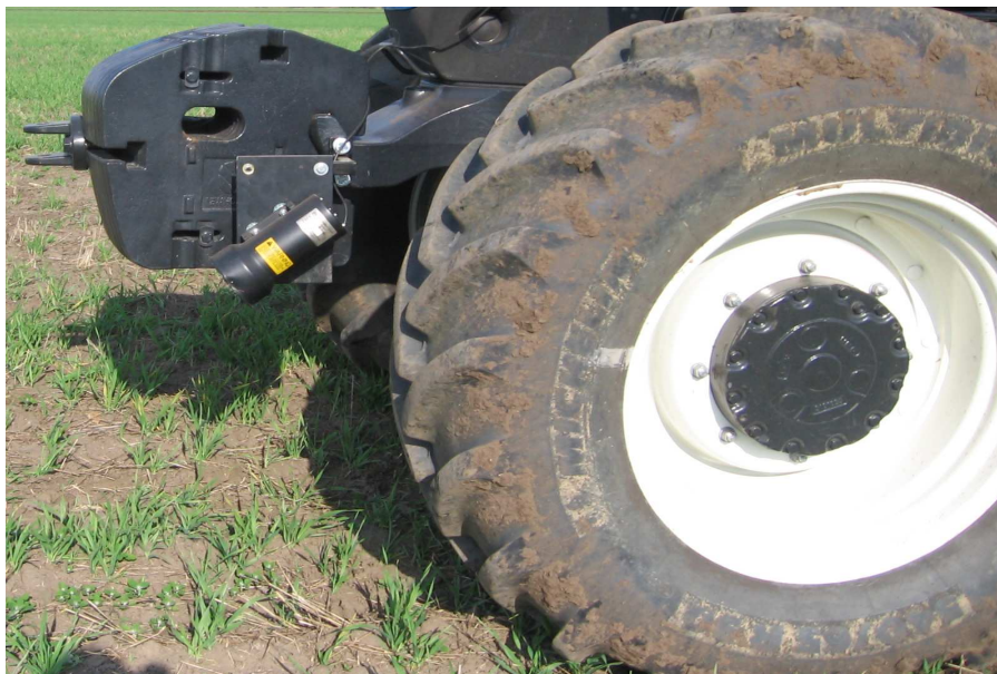
Obr. 4 Snímač otáček zadního kola traktoru
