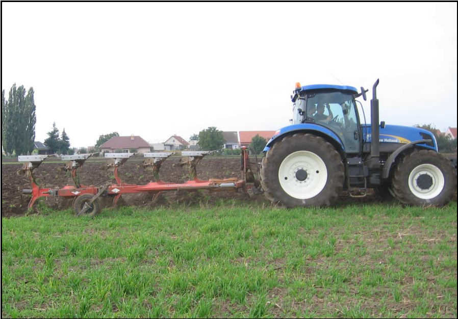
Obr. 2 Souprava traktoru NH T7050 s pluhem HUARD Variomaster 150
