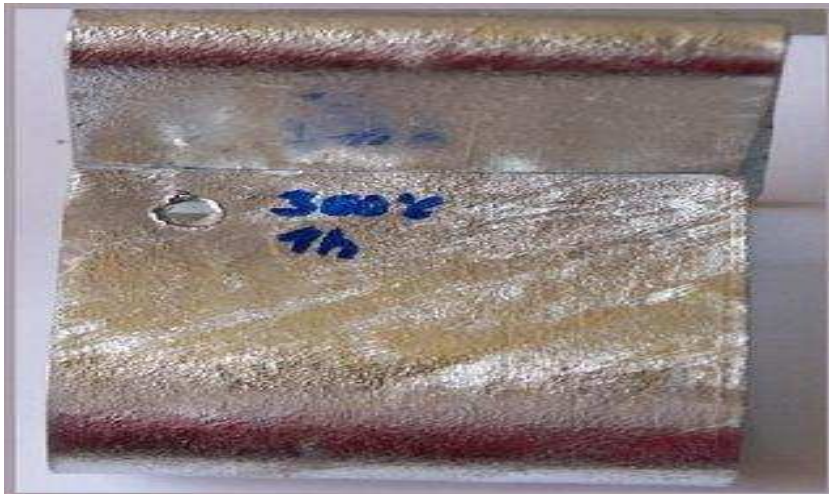
Obr.2 Ukázka připraveného žárově zinkovaného vzorku
