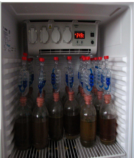
Obr. 2 Anaerobní kvasné láhve v klimaboxu
