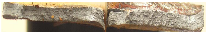
Obr. 6 Lomová plocha vzorku mat. 11 523 svařených metodou MAG v korozní atmosféře NaCl
