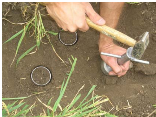
Obr. 2 Odběr půdních vzorků
