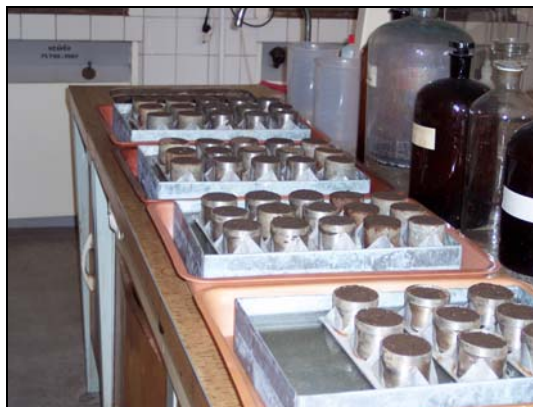
Obr. 3 Sycení půdních vzorků
