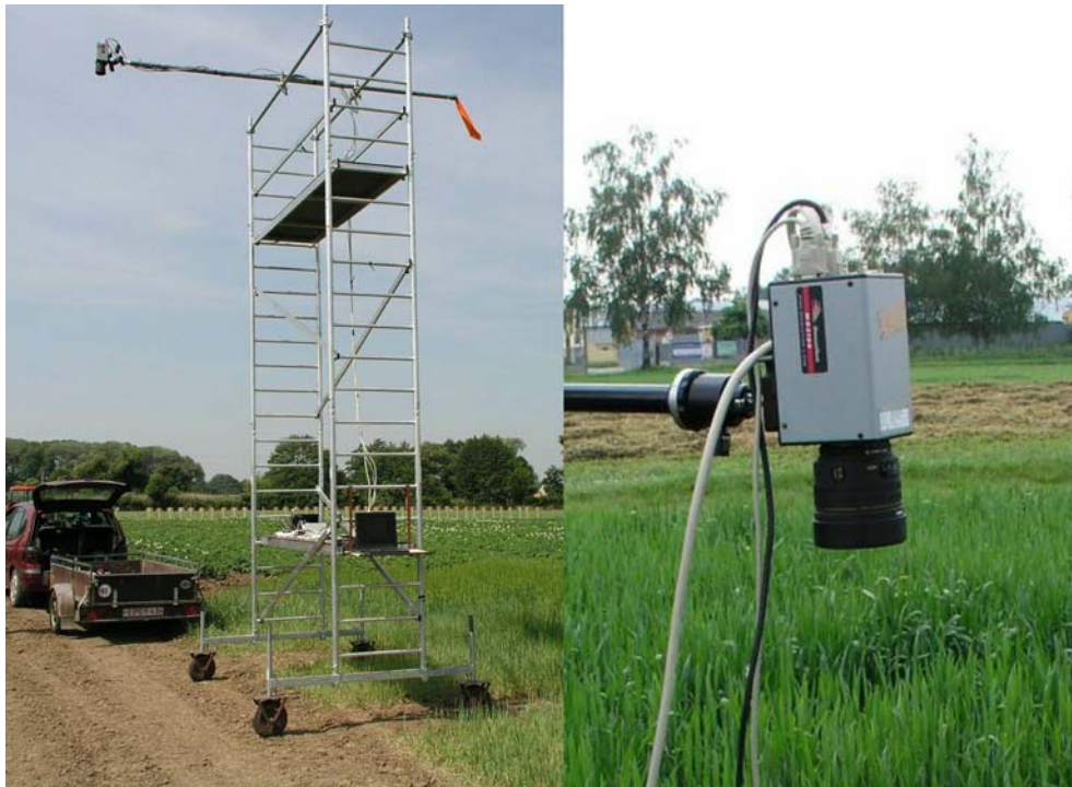
Obr. 1 Fotografie multispektrální kamery na pojízdné konstrukci a detail kamery
