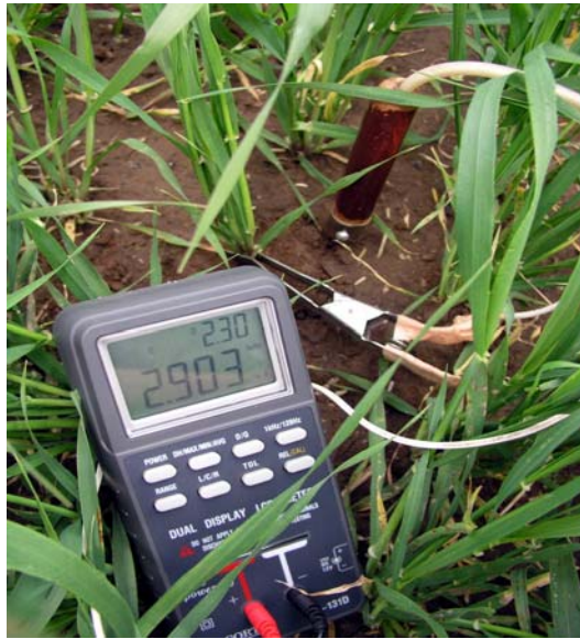
Obr. 1 Měření velikosti kořenového systému podle jeho elektrické kapacity (metoda Chloupek 1972, 1977)
