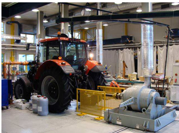
Obr. 2 Připojení traktoru k vířivému dynamometru V 500
