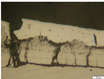
Obr. 9. Metallografický snímek odlupující vrstvy u vzorku popuštěného 1h při 300 °C
