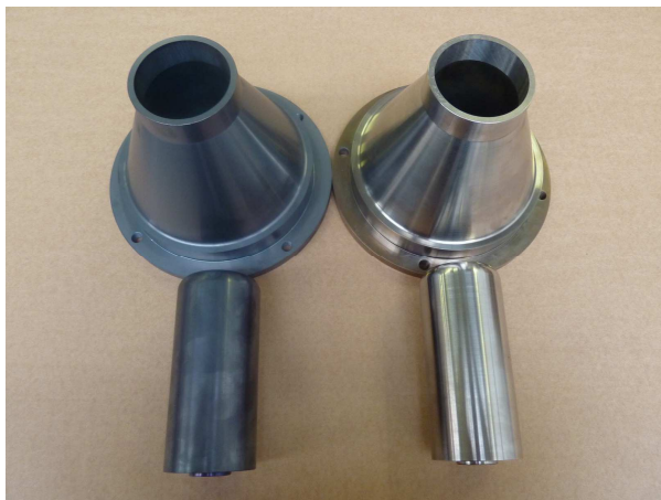
Obr. 9: Součásti forem připravené ke zkoušce (vlevo povlakované )
