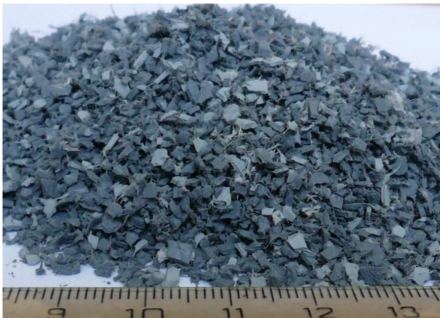
obr. 2 – výsledný produkt - recyklát (drť) PVC
