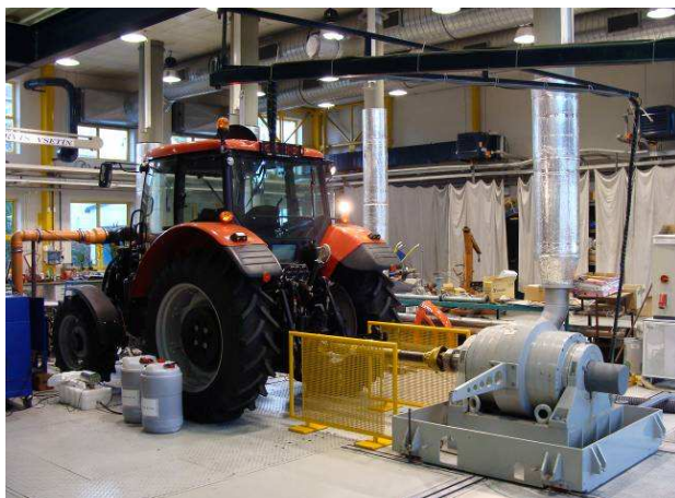
Obr. 2 Připojení traktoru k vířivému dynamometru V 500
