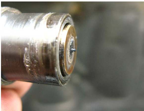
Obr.1: Detail vstřikovače s čepovou tryskou, vznětový motor s nepřímým vstřikováním, Fiat 1,9 TD
