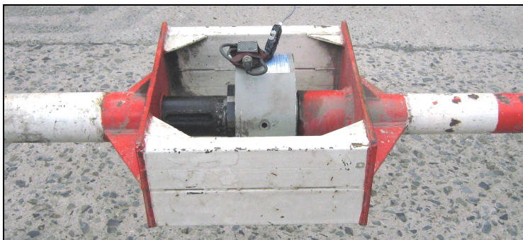
Obrázek 2. Tenzometrický snímač síly HBM Z4
