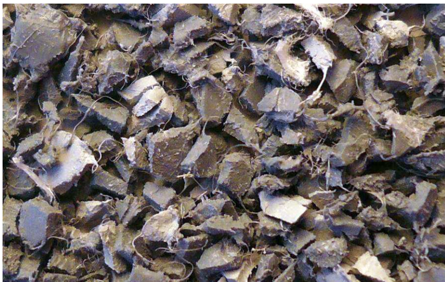
obr. 3 – recyklát (drť) PVC – detail částic se zbytkovými vlákny
