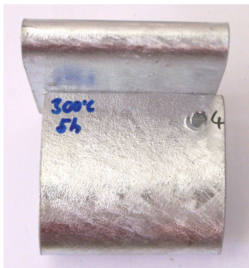
Obr. 4. Vzorek 160x65x1,0 po zkoušce ohybem
