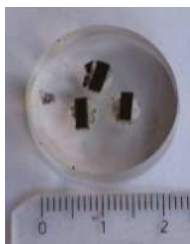
Obr. 1: Řezy korodovaného vzorku v pryskyřici
