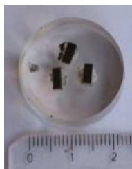
Obr. 1: Řezy korodovaného vzorku v pryskyřici
